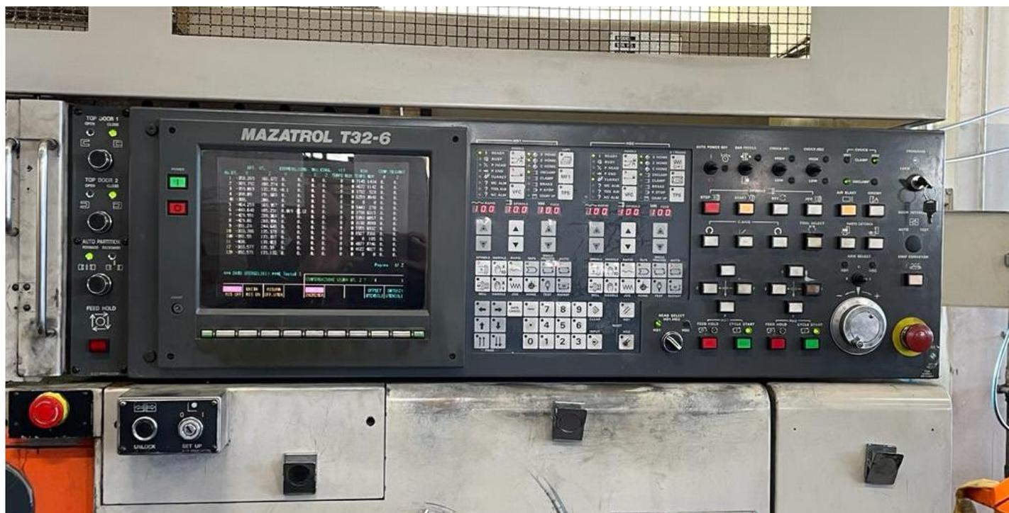
Dettaglio dell'interfaccia CNC Mazatrol T32-6
